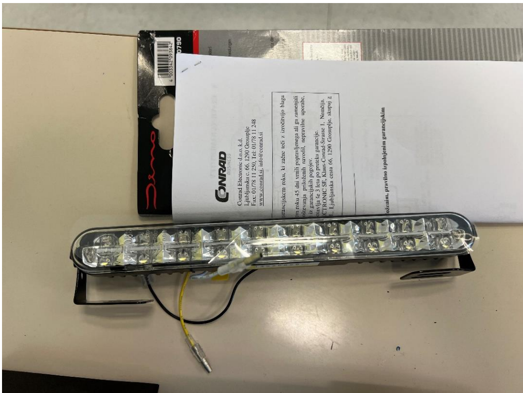
Slika 6: Prednje luči za električni skiro [3]
